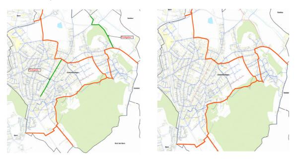
Das erste Zielsystem umfasst somit die Aufgabe der Verbindungen zu den stillgelegten Pumpwerken Bachstrasse und Rörswil. Die Verbindungen des Reservoir Rüti über die Bernstrasse in Richtung Stettlen, mit dem Pumpwerk Bad und mit dem Pumpwerk Chrützweg bleiben weiterhin Teile des Primärsystems.
