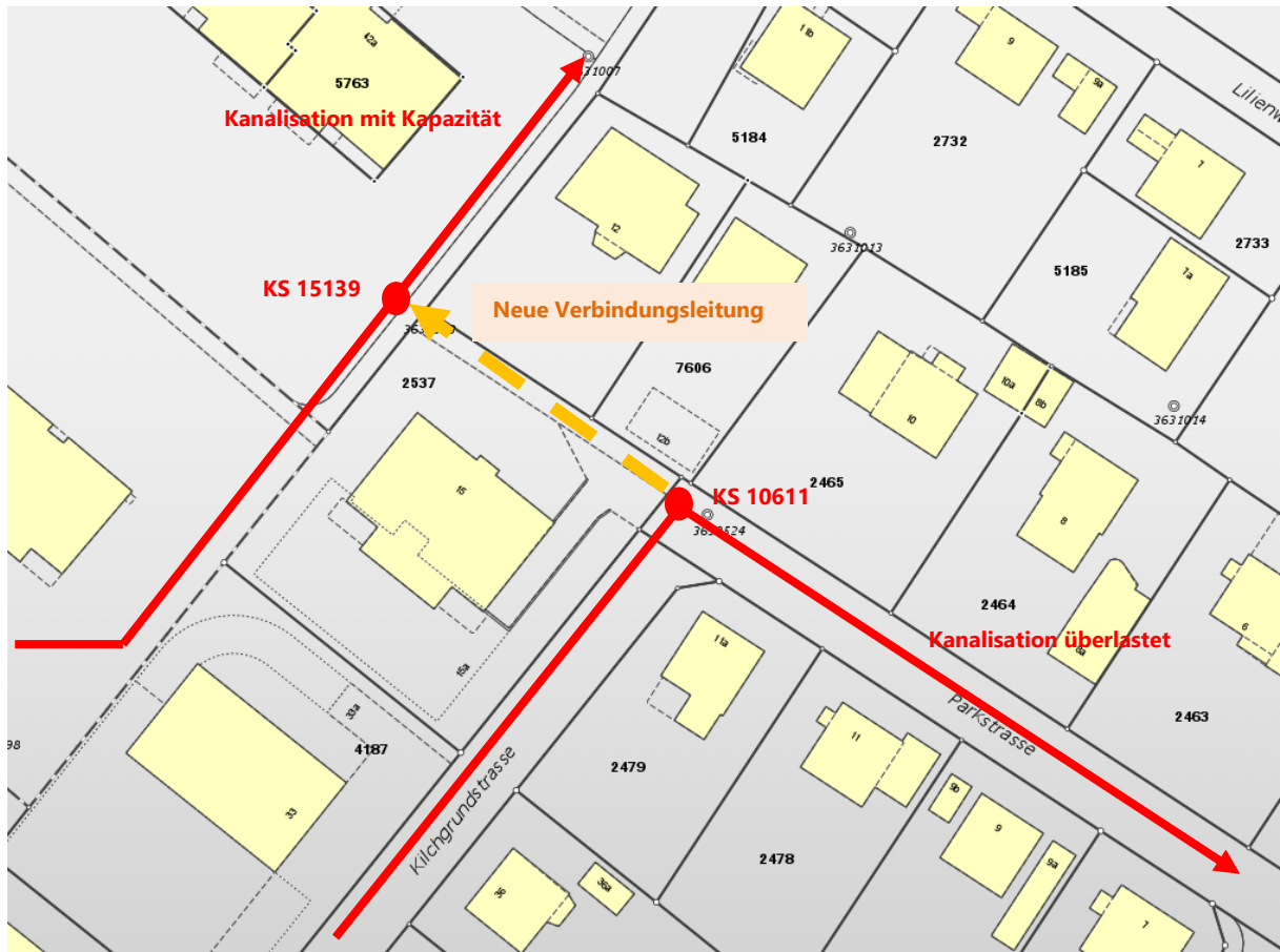
Abbildung 1: Die neue Verbindungsleitung (orange gestrichelt), welche die überlastete Kanalisation beim KS 10611 mit der gegenüberliegenden Kanalisation welche noch genügend Kapazität hat, zum KS 15139 verbindet. Sobald der Wasserstand in der überlasteten Kanalisation eine bestimmte Höhe überschreitet, entlastet diese in die gegenüberliegende Kanalisation.
