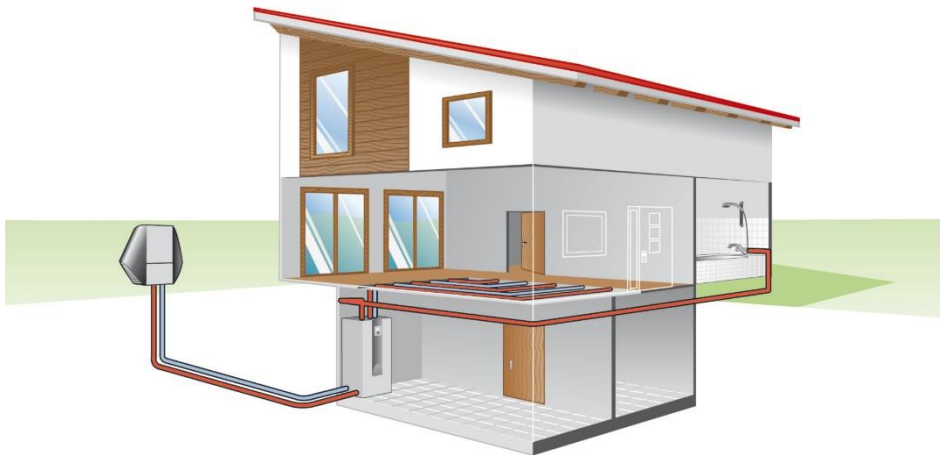
Abbildung 25: Abbildung Beispiel einer Luftwärmepumpe.
