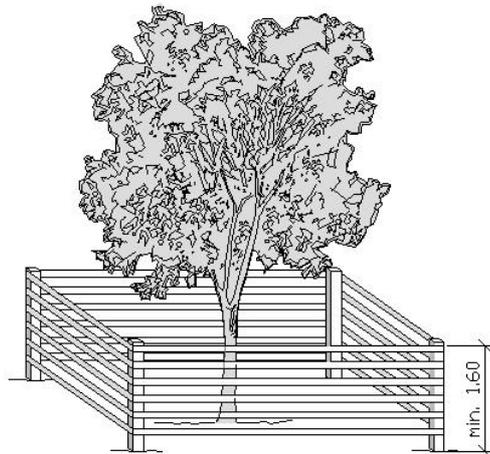
Bei gefährdeten Bäumen im freien Gelände ist der gesamte Wurzelbereich mit einem massiven Baumzaun zu schützen; bei unvermeidlichen Abgrabungen im Wurzelbereich ist je nach Situation vor Beginn der Grabarbeiten ein Wurzelvorhang zu erstellen.
