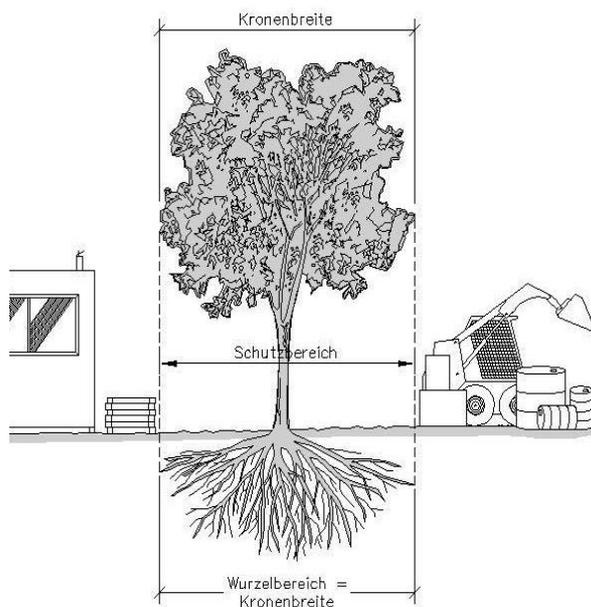
Im Wurzelbereich von bestehenden Bäumen (entspricht in der Regel dem Kronenbereich) dürfen keinerlei Baumaterialien oder Treibstoffe gelagert und keine Baumaschinen installiert werden. Der Wurzelbereich darf nicht befahren werden.
