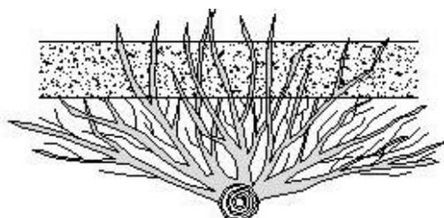
Grabarbeiten im Wurzelbereich von bestehenden Bäumen dürfen nur mit ausdrücklicher Genehmigung vom TBA vorgenommen werden. Die Grabarbeiten sind von Hand auszuführen, Wurzeln dürfen nicht abgerissen oder gequetscht werden, dickere Wurzeln (über daumendick) dürfen nur durch das TBA abgetrennt werden. Freigelegte Wurzeln sind mit einer Folienabdeckung vor dem Austrocknen zu schützen.
