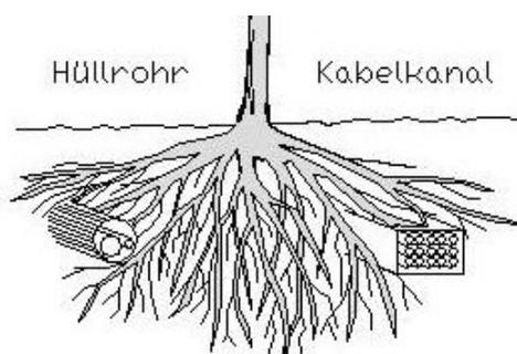
Werkleitungen müssen ausserhalb des Wurzelbereiches eingebaut werden. Ist dies nicht möglich, müssen die Grabarbeiten von Hand ausgeführt und die Werkleitungen in Hüllrohren oder Kanäle verlegt werden
