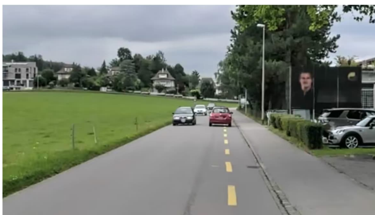
Abbildung 6 Begegnungsfall PW - PW mit Ausweichen auf Radstreifen
