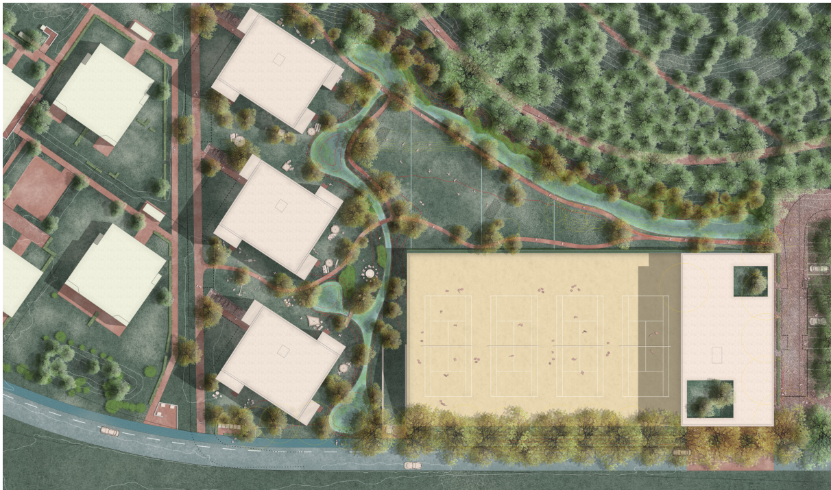
Abb. 15: Entwässerungskonzept mit Versickerungsmulden
