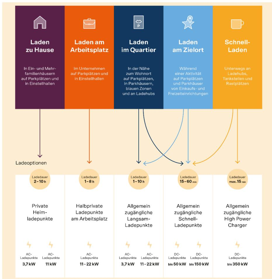
Abbildung 14: Eigenschaften der fünf Ladebedürfnisse (oben) und zugeordneten Ladestationstypen (unten).
