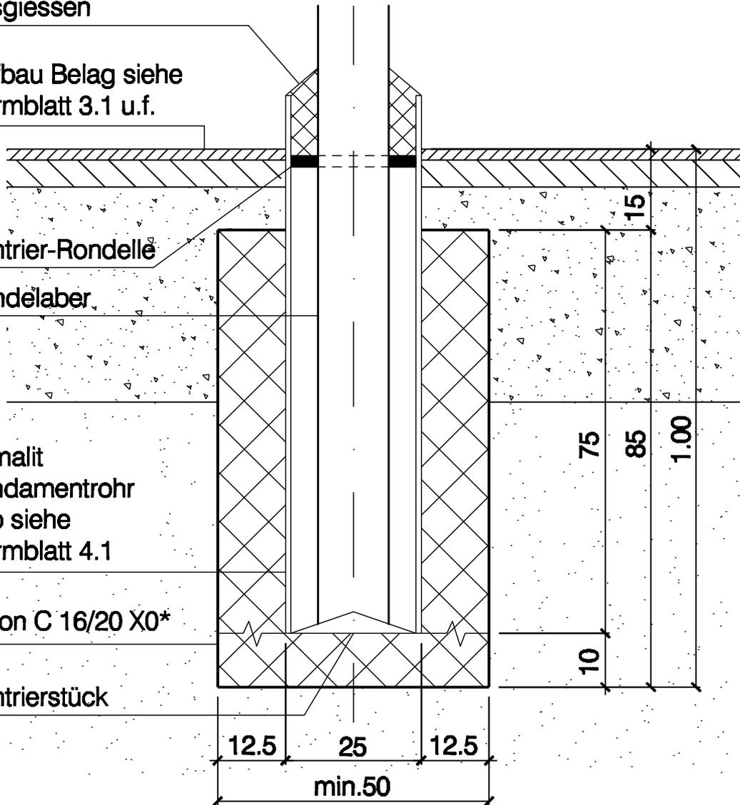
\* Alte Betonbezeichnung: B 25/15, PC 250kg/m<sup>3</sup>
