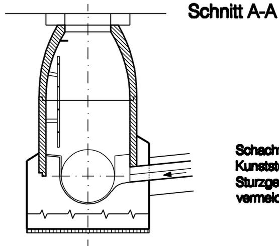
Schachtfutter bei Kunststoffrohren Sturzgefälle vermeiden
