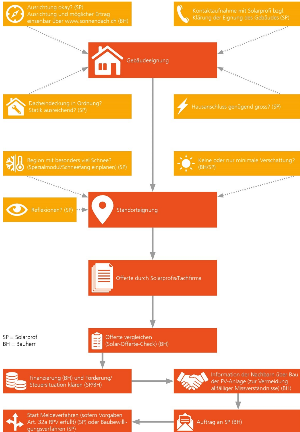
Abbildung 5: Schritt für Schritt bis zur eigenen Solaranlage
